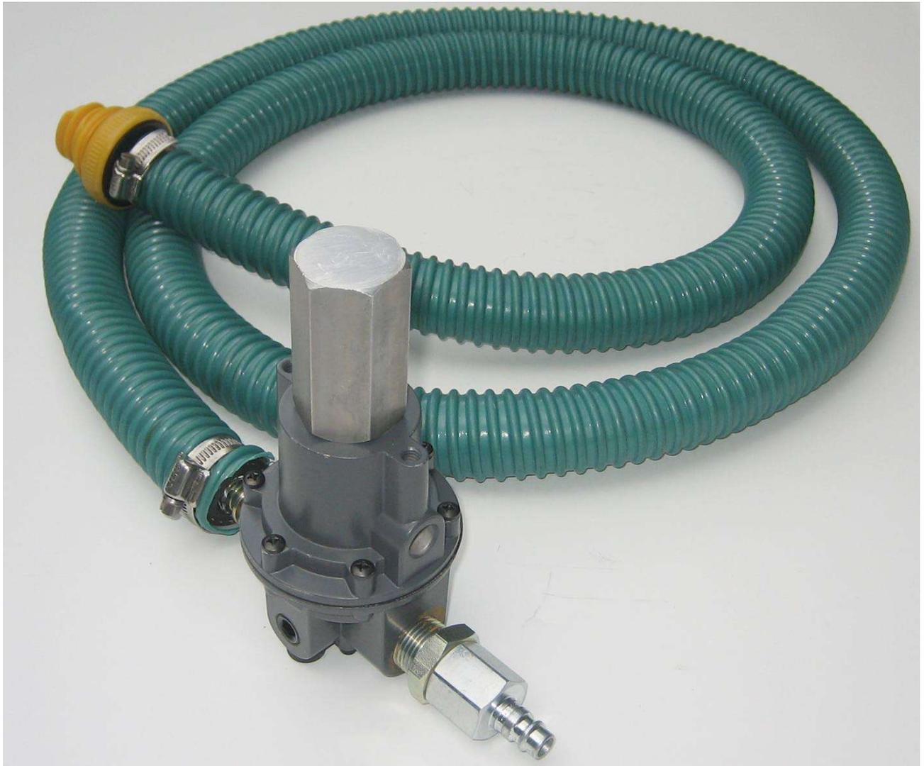
Der NOAQ Druckwächter ist ein Zubehörteil für den NOAQ Schlauchwall. Er ermöglicht den Anschluss eines Schlauchwalls an einen Kompressor oder ein Druckluftsystem. Der Druckwächter besteht aus einem Drosselventil, das den Luftdruck innerhalb des empfohlenen Intervalls konstant hält, ca. 7 kPa (70 mbar oder 1 psi). Sollte ein Luftleck auftreten, sorgt der Druckwächter für eine sofortige Wiederherstellung des Luftdrucks im Schlauchwall.
